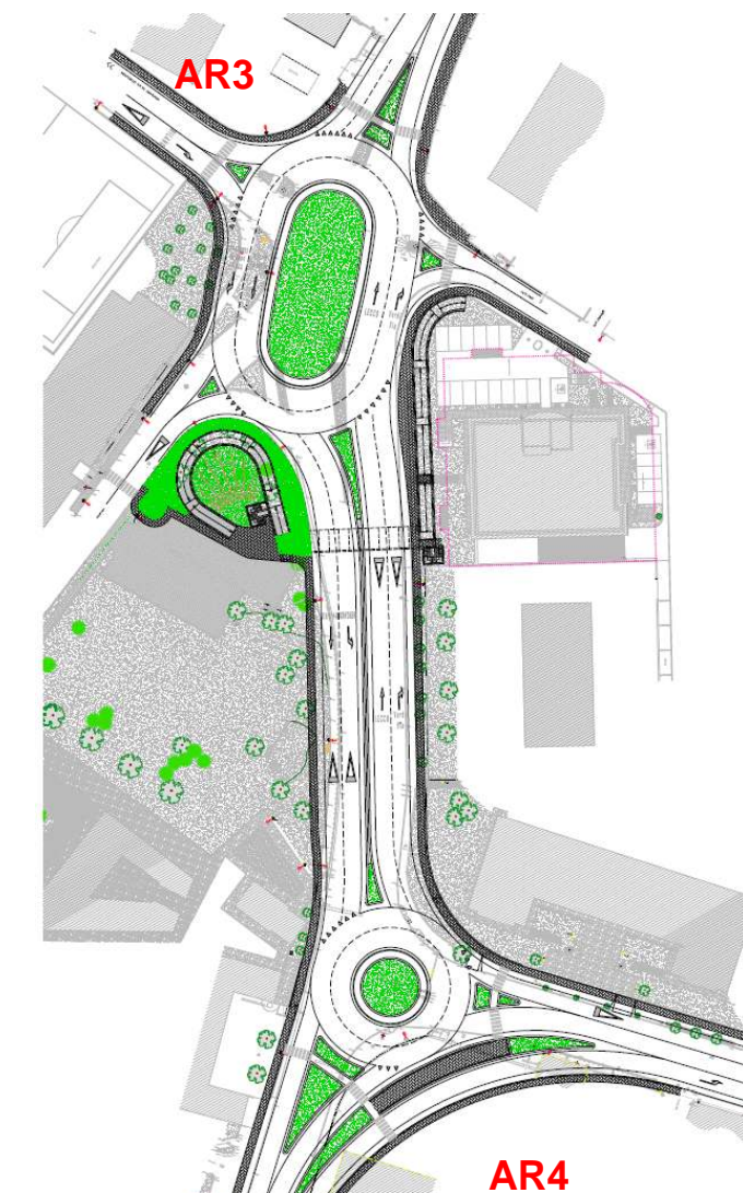
Estratto del progetto preliminare della doppia rotatoria
