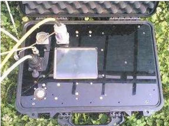
L'intero processo comprende tre passi successivi: L'acquisizione delle onde superficiali (ground roll), la costruzione di una curva di dispersione (il grafico della velocità di fase rispetto alla frequenza) e l'inversione della curva di dispersione per ottenere il profilo verticale delle  $V_s$ . Per ottenere un profilo  $V_s$  bisogna produrre un treno d'onde superficiali a banda larga e registrarlo minimizzando il rumore.
